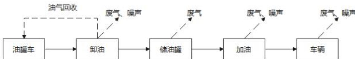
图 3.5-1 加油工艺流程及排污节点图
