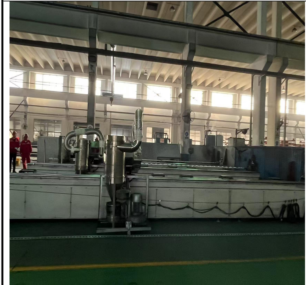
抛光机床附带旋风除尘器
